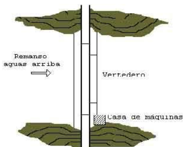
Figura 6: Esquema de funcionamiento de una central hidroeléctrica fluyente. (Vista en planta).
