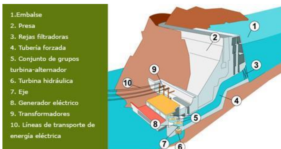
Figura 5: Esquema de funcionamiento de una central hidroeléctrica de embalse.
